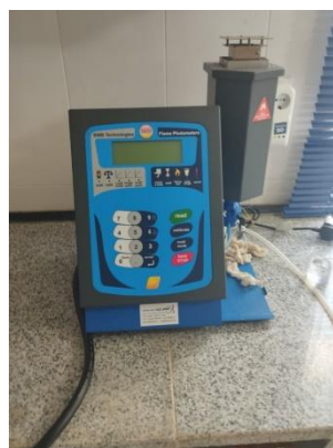
شکل ۴: دستگاه فلیم فتومتر برای اندازه‌گیری کاتیون و آنیون آب
