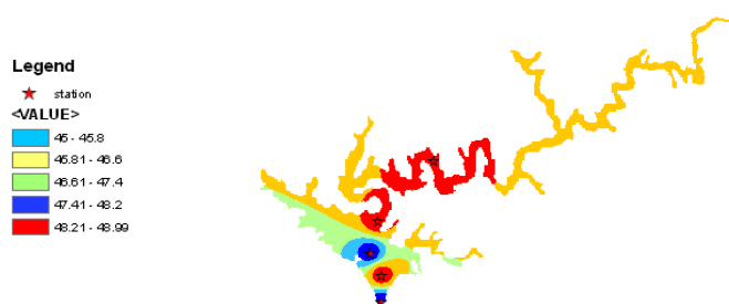
شکل ۵: پهنه‌بندی کیفی دریاچه سد دز برای شاخص TSI.
