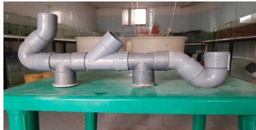
شکل ۲: بیوفیلتر طراحی شده (آزمایشگاهی) برای تصفیه پساب خروجی در سیستم باز گردش آب
