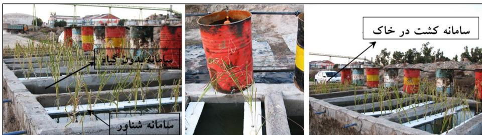
شکل ۲: نمایی از سامانه‌های تالاب مصنوعی مورد استفاده در تحقیق.
